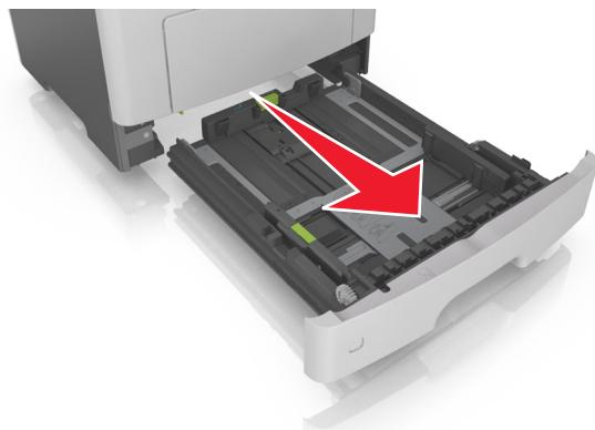
**2** Сожмите, а затем передвиньте направляющую ширины в положение, соответствующее формату загружаемой бумаги.
