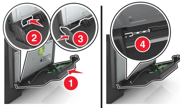
**10** Протяните кабель ISP через дверцу защитного чехла системной платы.
