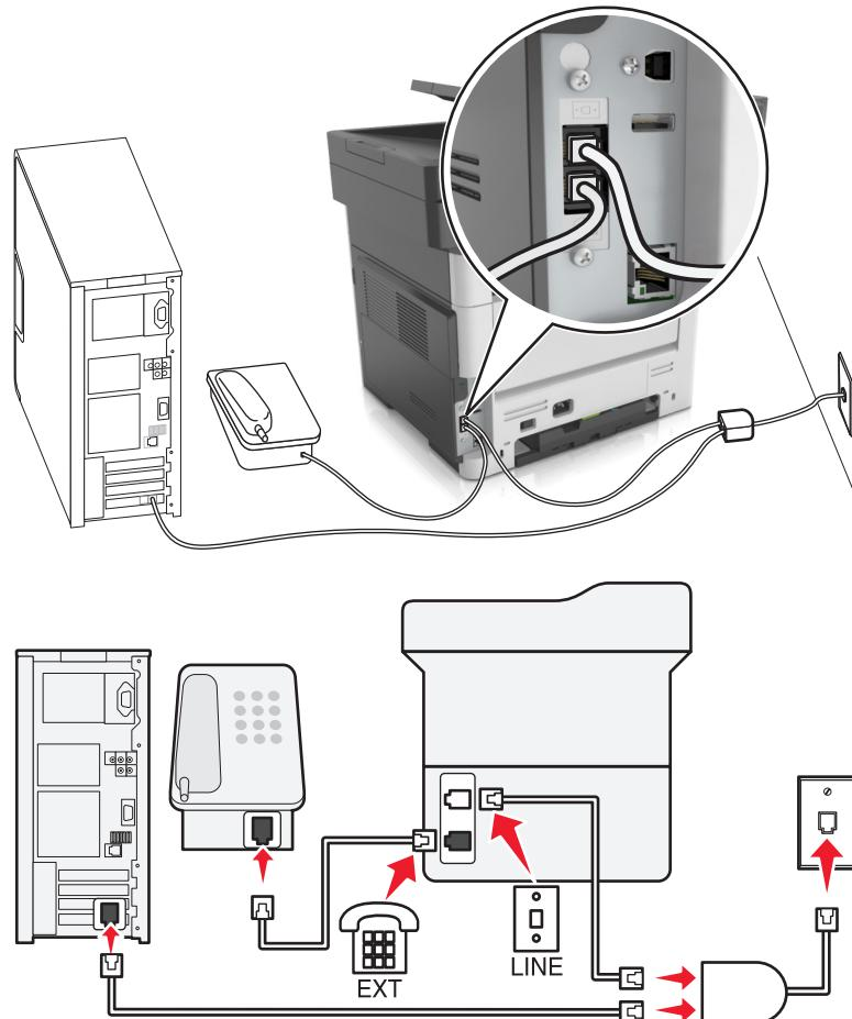
Линия DSL разделяет обычную телефонную линию на два канала: голосовой и Интернет. Сигналы телефона и факса передаются по голосовому каналу, а сигналы Интернета – по другому. Таким образом одну линию можно использовать для аналоговых голосовых вызовов (включая факсы) и для цифрового доступа в Интернет.
