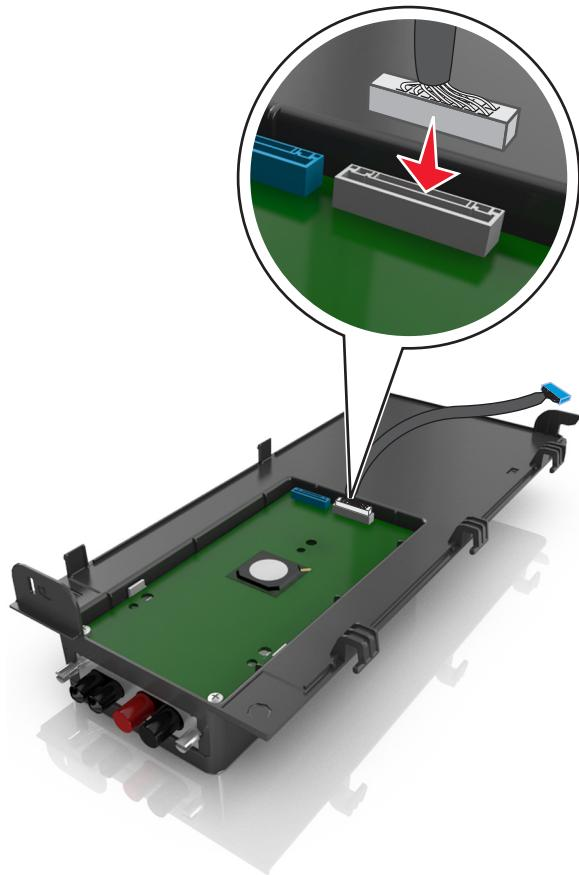
**9** Прикройте внешнюю крышку ISP приблизительно на 65 градусов, а затем сдвиньте ее для закрепления.
