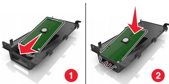
6 Прикрепите решение ISP к пластиковому вкладышу с помощью длинного винта.
