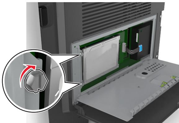
4 Закройте защитный чехол платы контроллера и закройте дверцу для доступа к плате.
