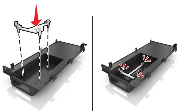
5 Сдвиньте и втолкните решение ISP внутрь пластикового вкладыша.
