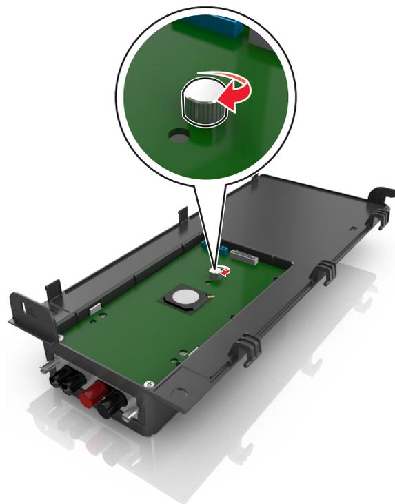
**7** Затяните два винта на конце решения ISP.
