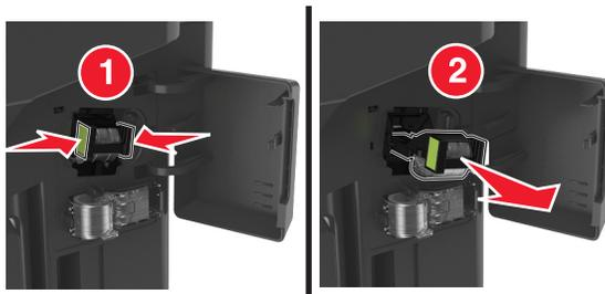
3 Сожмите пустую кассету со скрепками с обеих сторон пальцами, вытяните, и поднимите пустую кассету со скрепками из картриджа.
