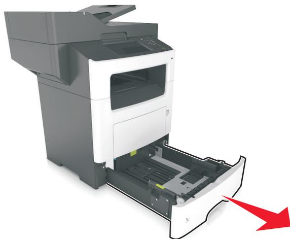
**2** Сожмите, а затем передвиньте направляющую ширины в положение, соответствующее формату загружаемой бумаги.
