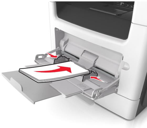
**ПРЕДУПРЕЖДЕНИЕ. Возможность повреждения:** Не используйте конверты со штампами, зажимами, застежками, окнами, подкладкой и самоклеющимися деталями. Использование таких конвертов может привести к серьезному повреждению принтера.
