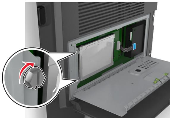
4 Закройте защитный чехол платы контроллера и закройте дверцу для доступа к плате.
