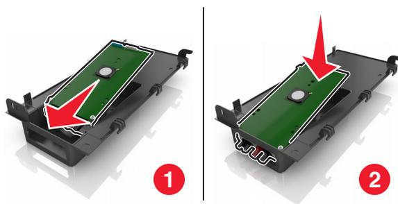
6 Прикрепите решение ISP к пластиковому вкладышу с помощью длинного винта.
